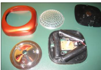
Er besteht aus einem Metallgehäuse, einem Batteriefach mit Platine, da ist die LED-Lampe drauf geklebt, einem Spiegeltrichter, einem durchsichtigen auf einer Seite genoppten Deckel und einem Deckel für das Batteriefach mit Magnetplättchen und einem Klebeplastikstück (zur Befestigung der Lampe) Um die LED Lampe auseinanderzunehmen, muss man dazu das Metallgehäuse vom Batteriefach mit der Platine lösen. Da es angeklebt wurde, ist es etwas knifflig.
